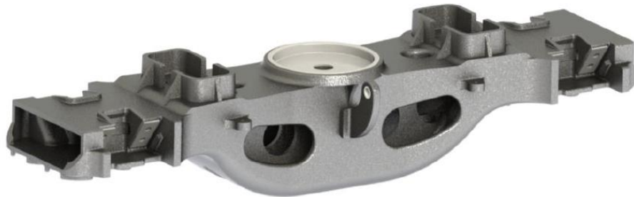
Fig.2 vista de la traviesa 3D
